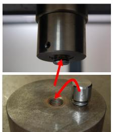
標準の負荷子は、中央部に専用ボルトをねじ込み、その凸部を固定具に差し込んで固定する構造になっています。
